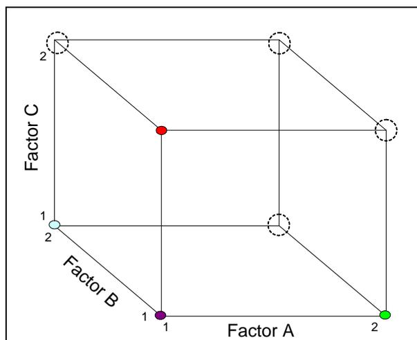
Figura 5. Factorial de 3 factores ilustrando combinaciones sin explorar al utilizar el método de variar un factor a la vez.
